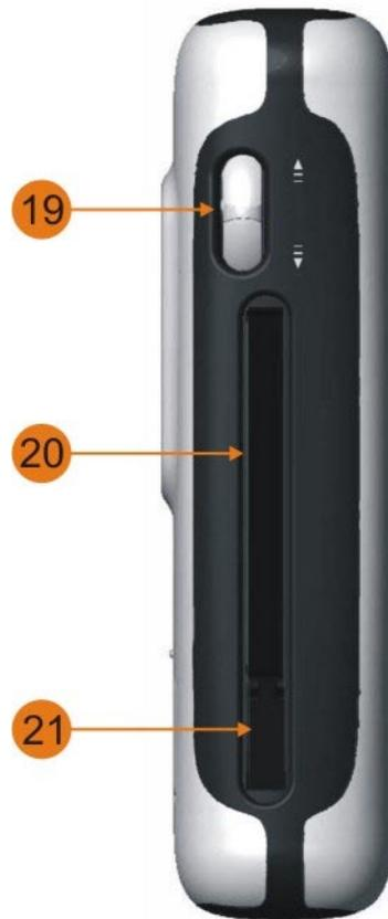
19. **NAVホイール**：マルチ機能のホイールで、MicroTrack 24/96の現在の再生状態によりメニューが変化します。
